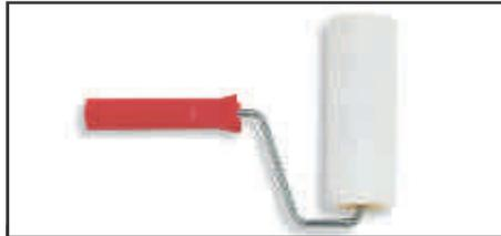
**3880 Entlüftungsroller**, Dornen zum Aufstechen von Bläschen beim Verarbeiten zähflüssiger Materialien, Stachelänge 12mm
