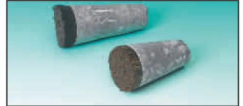
Die Borsten werden aus der Pappumreifung entfernt und in konische Metallhülsen mit den Borstenfahnen voraus eingefüllt.
