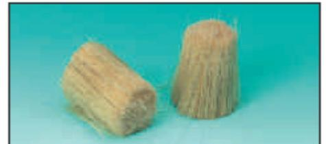
Nach dem Kochvorgang werden die in den Hülsen enthaltenen Borsten in Trockenöfen getrocknet. Nach einer Trocknungszeit von vier Stunden werden die Borsten den Hülsen entnommen. Die Borsten kleben jetzt zusammen und müssen nun mittels Spezialmaschinen gemischt werden.
