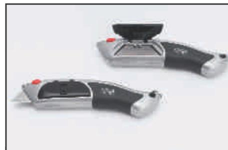
**4095 Profi-Teppichbodenmesser**, mit Klingensmagazin incl. 3 Ersatzklingen, Klingenwechsel in Sekunden auf Knopfdruck durch automatische Nachführung bei Entnahme der stumpfen Klinge.
